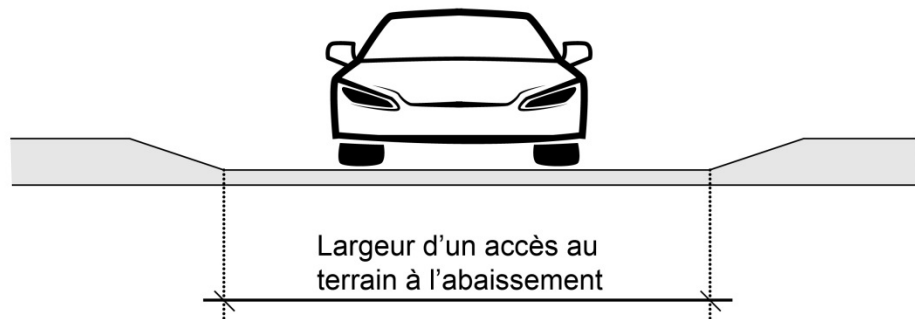
Figure 10.4 Largeur d'un accès au terrain à l'abaissement
